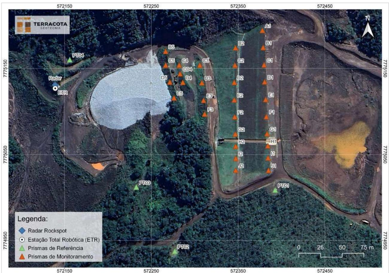
**Figura 13.5** – Planta de localização dos prismas da barragem.
